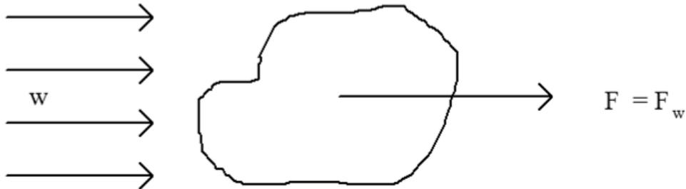
Abb. 10-13: Widerstand bei plumpen Körpern
