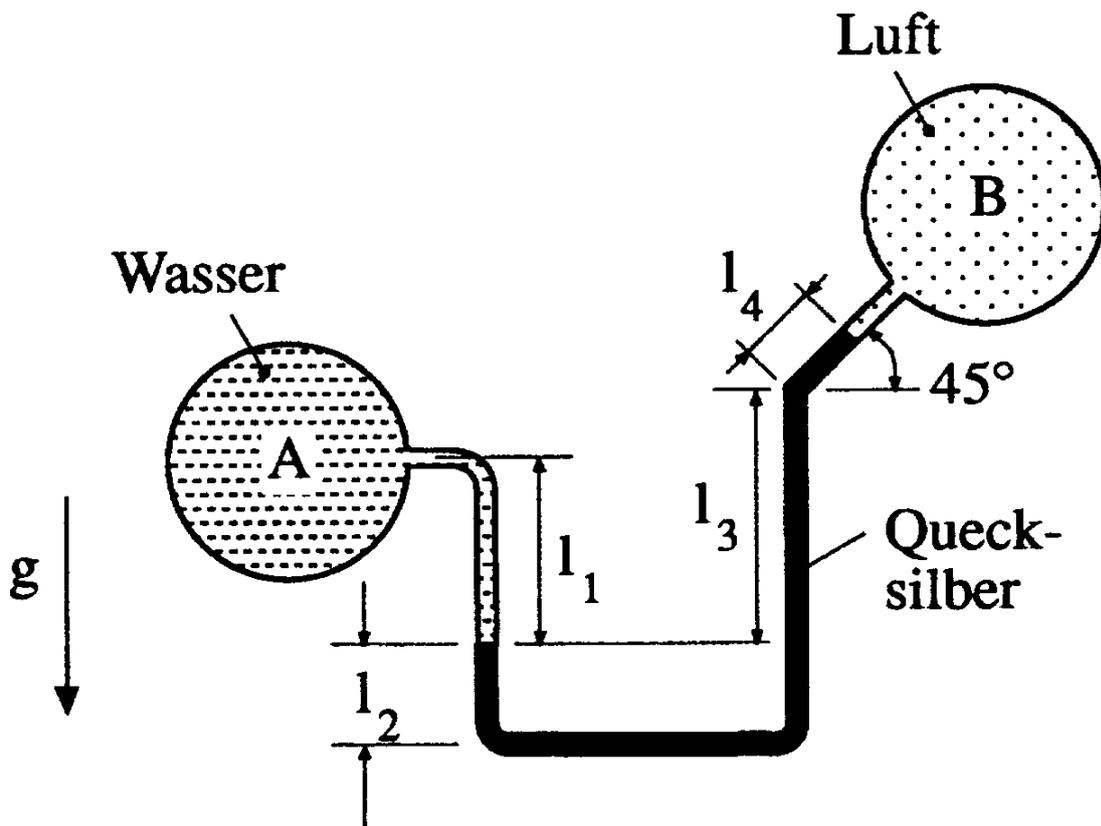
Bestimmen Sie die Druckdifferenz  $\Delta p_{AB}$  zwischen Tank A und Tank B.
