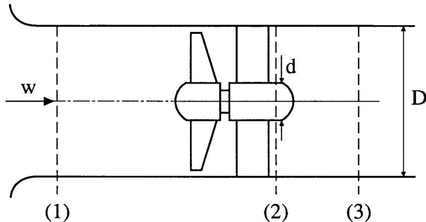
Die Untersuchung eines Axialventilators reibungsloser Strömung auf dem Prüfstand ergab die Werte  $p_1$ ,  $p_2$ , und  $p_3$  für die statischen Drücke, die mit einem **Manometer** gemessen wurden. Die Wellenleistung des Motors sei  $P_W$ .
