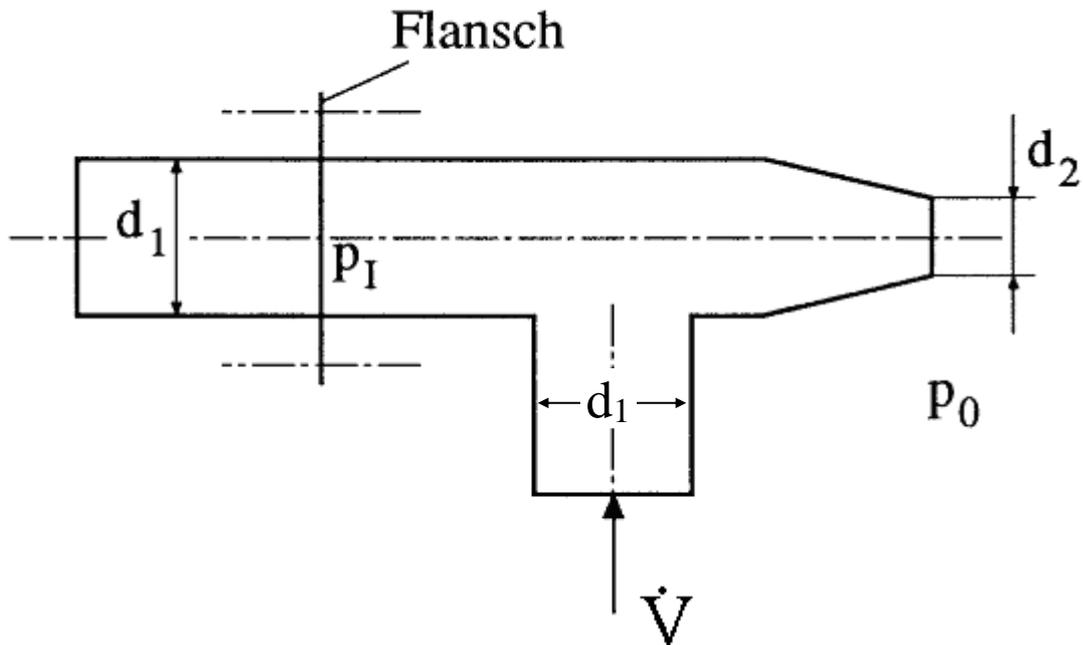
Gegeben:  $\dot{V} = 0,25 \text{ m}^3/\text{s}$      $\rho = 1000 \text{ kg/m}^3$      $p_0 = 1 \text{ bar}$
