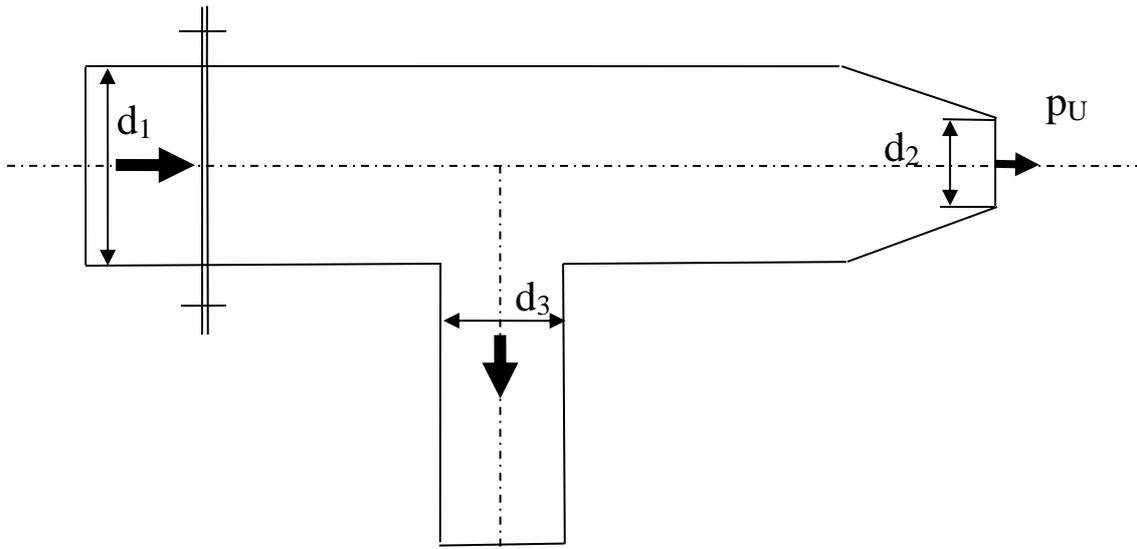
**Gegeben:**  $\dot{V}_1 = 0,25 \text{ m}^3/\text{s}$      $\rho = 1000 \text{ kg/m}^3$      $p_U = 1 \text{ bar}$
