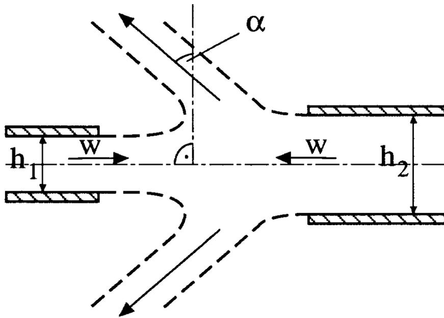
Aus zwei Schlitzen der Breite  $b$  mit den Höhen  $h_1$  bzw.  $h_2$  treten freie Strahlen mit der Geschwindigkeit  $w$  aus und treffen aufeinander. Die Anordnung ist symmetrisch zur mittleren Strömungsebene.
