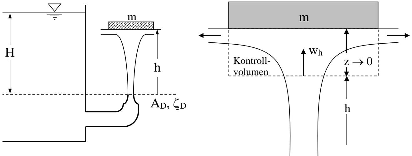
Aus einer an einem großen Behälter angeschlossenen Düse tritt ein senkrechter Wasserstrahl (Dichte  $\rho$ ) aus. Druckverluste treten nur in der Düse auf (Verlustbeiwert  $\zeta_D$ , Querschnitt  $A_D$ ). Der Düsenaustritt liegt um die Höhe  $H$  unter der Wasseroberfläche. Zu Versuchszwecken wird eine Platte der Masse  $m$  mit seitlicher Führung in den Strahl gebracht, die Entfernung vom Düsenaustritt stellt sich zu  $h$  ein.
