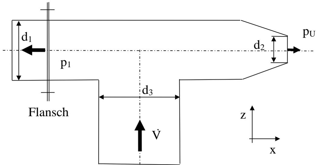
Gegeben:  $\dot{V}_1 = 0,25 \text{ m}^3/\text{s}$      $\rho = 1000 \text{ kg/m}^3$      $p_U = 1 \text{ bar}$
