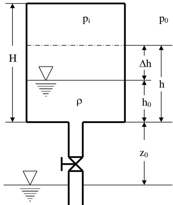
1. Für einen bestimmten Innendruck  $p_{i^*}$  kommt es nach dem Öffnen des Sperrventils zu keinem Anstieg des Wasserspiegels ( $\Delta h = 0$ )? Wie groß muss  $p_{i^*}$  für diesen Fall sein?
