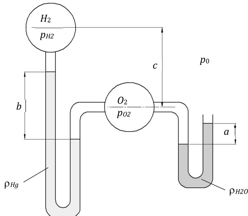
**Gegeben:**  $\rho_{H_2O} = 1000 \text{ kg/m}^3$      $\rho_{Hg} = 13\,550 \text{ kg/m}^3$      $g = 9,81 \text{ m/s}^2$
