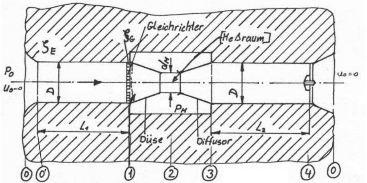
In einem verlassenen Bergwegstollen soll ein Unterschallwindkanal mit einem kreisförmigen Querschnitt (Zuluftkanaldurchmesser  $D$ ) installiert werden. Im gesamten Kanal ist bei einem Volumenstrom  $\dot{V}_L$  von inkompressiblem Verhalten der Luftauszugehen.
