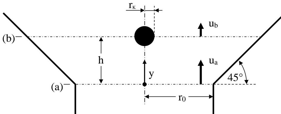
Die dargestellte Anordnung kann zur Messung des Volumenstroms  $\dot{V}$  benutzt werden. Sie besteht aus einem vertikalen Glasrohr mit sich nach unten verringerndem Querschnitt und einem Schwebekörper (Kugel; Dichte  $\rho_K$ , Radius  $r_K$ , Widerstandsbeiwert  $c_W$ ), der sich im Flüssigkeitsstrom (Dichte  $\rho_F$ ) befindet. Mit der abzulesenden Schwebehöhe  $h$  kann der Volumenstrom mit den gegebenen Größen ermittelt werden.
