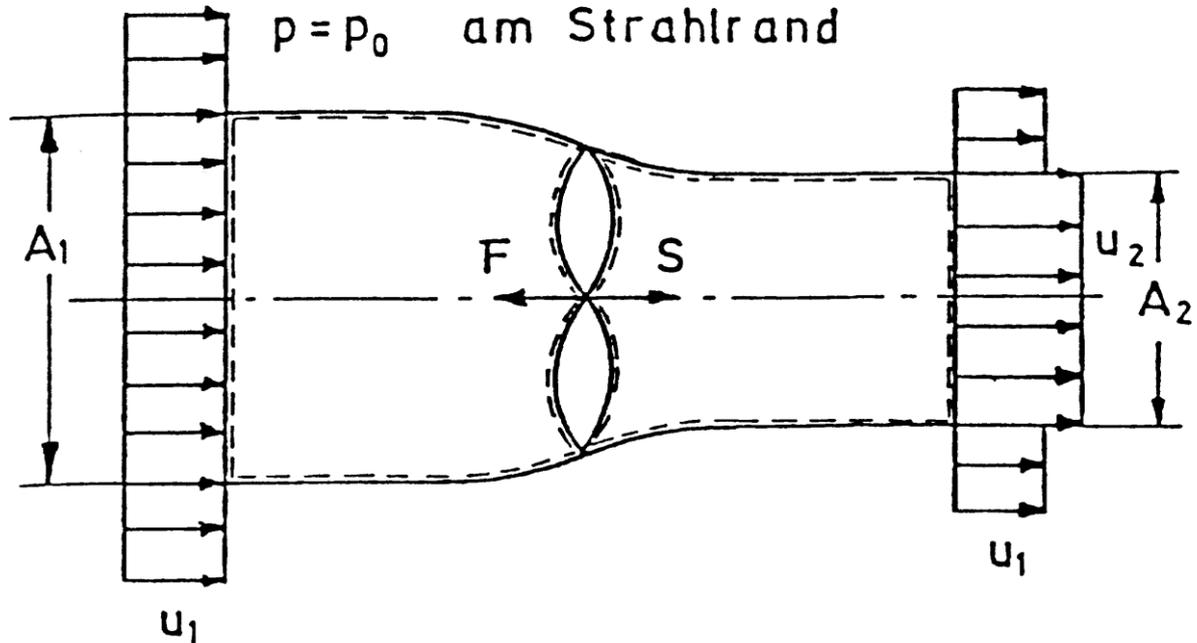
Es wird stationär für einen auf dem Propeller mitbewegten Beobachter. Für diesen Beobachter strömt das Fluid mit  $u_1$  in einem Strahl der Fläche  $A_1$  gegen den Propeller an und strömt in einiger Entfernung hinter dem Propeller als Strahl der Fläche  $A_2$  mit  $u_2$  ab.
