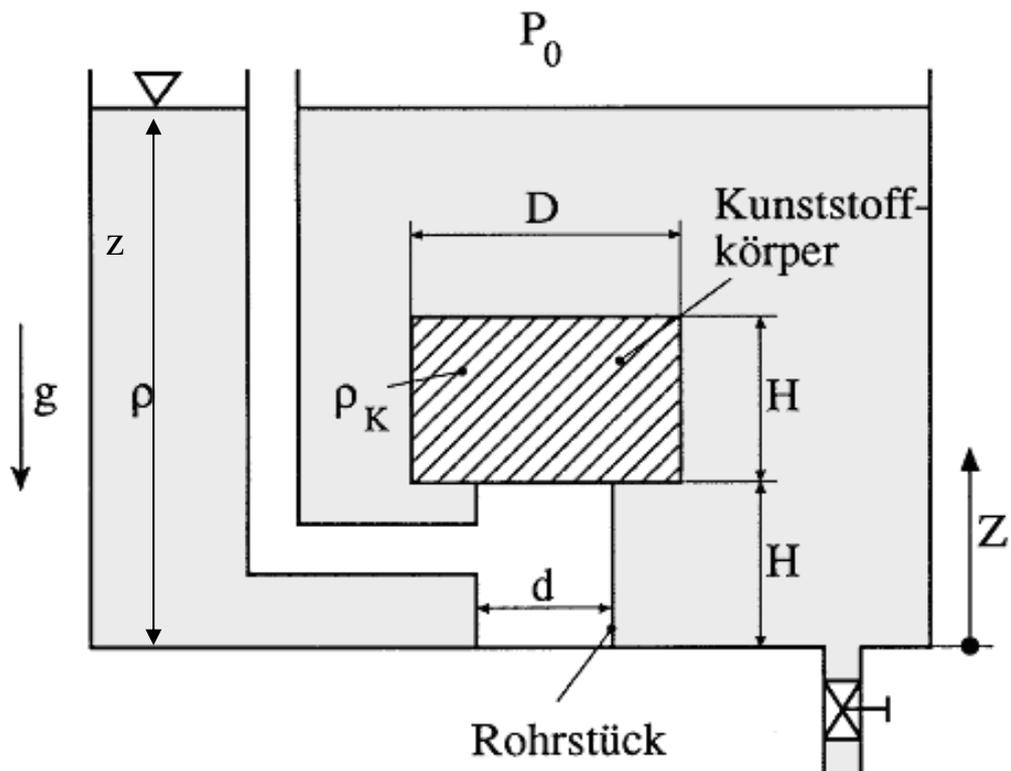
Ein zylindrischer Kunststoffkörper ( $\varnothing D$ ,  $H$ ,  $\rho_K$ ) liegt auf einem dünnwandigen Rohrstück ( $\varnothing d = \sqrt{0,5 \cdot D}$ ,  $H$ ) in einem großen Behälter. Die Dichte der Flüssigkeit sei  $\rho = 2 \cdot \rho_K$ . Das Rohrstück ist mit der Umgebung verbunden, in welcher der Druck  $p_0$  herrscht.
