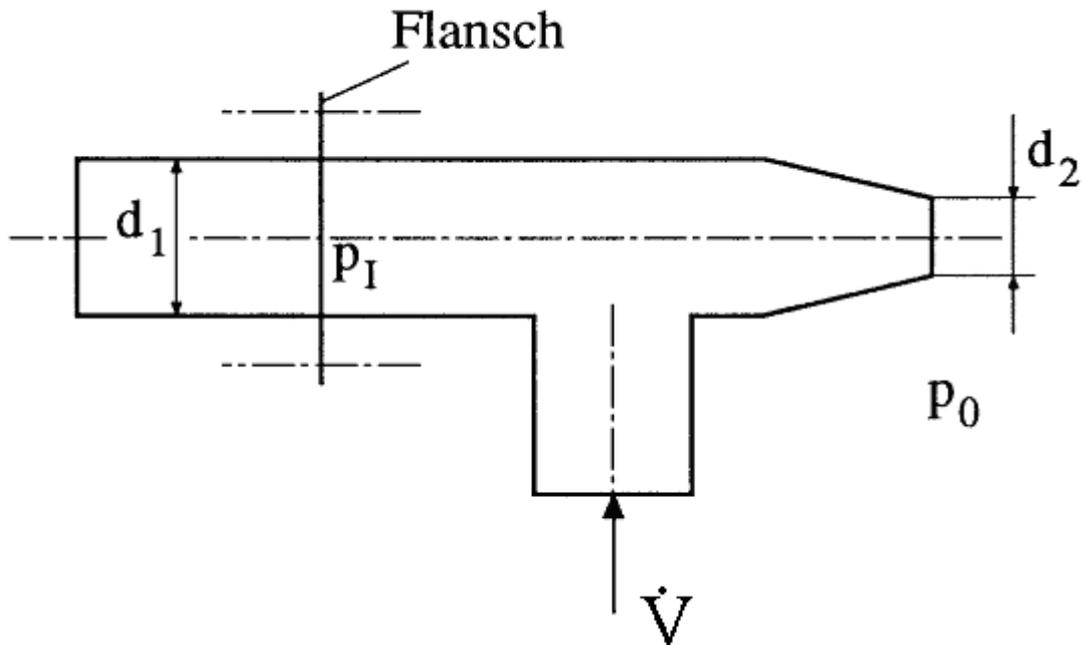
Gegeben:  $\dot{V} = 0,14 \text{ m}^3/\text{s}$      $\rho = 1000 \text{ kg/m}^3$      $p_0 = 1 \text{ bar}$
