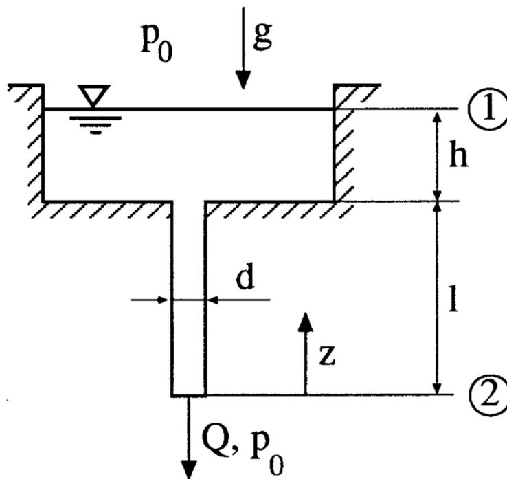
**Gegeben:**  $\dot{V} = 0,0932 \text{ m}^3/\text{s}$        $d = 0,1 \text{ m}$        $h = 5 \text{ m}$
