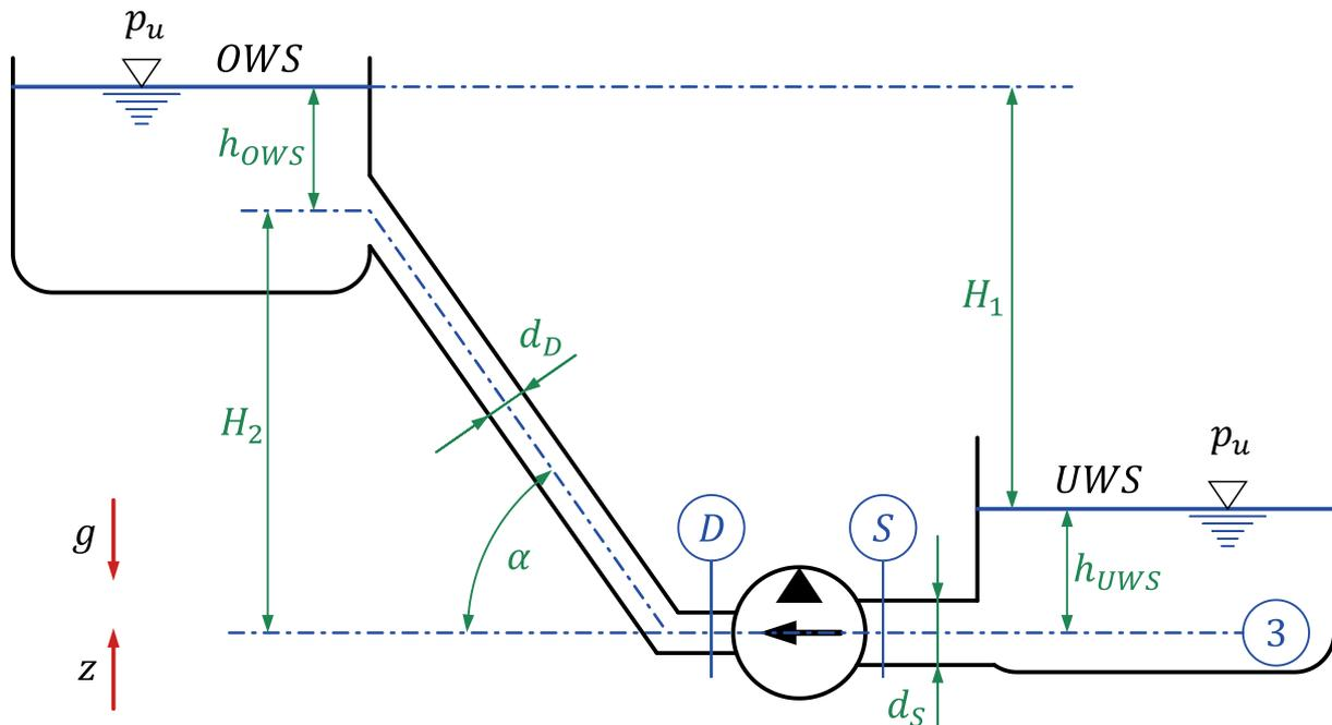
Der dazugehörige Stausee liegt 500 m über dem Unterwasserbecken. Die Höhendifferenzen  $H_1$  und  $H_2$  sind dabei gleich  $\rightarrow H_1 = H_2 = H$ . Die Rohrleitungen der Pumpenanlage haben auf der Saugseite einen Durchmesser von  $d_S = 2,5$  m und auf der Druckseite einen Durchmesser von  $d_D = 2,0$  m. Der Volumenstrom beträgt beim Pumpen des Wassers  $Q_P = 10$  m<sup>3</sup>/s. Der Luftdruck beträgt  $p_u = 1$  bar.
