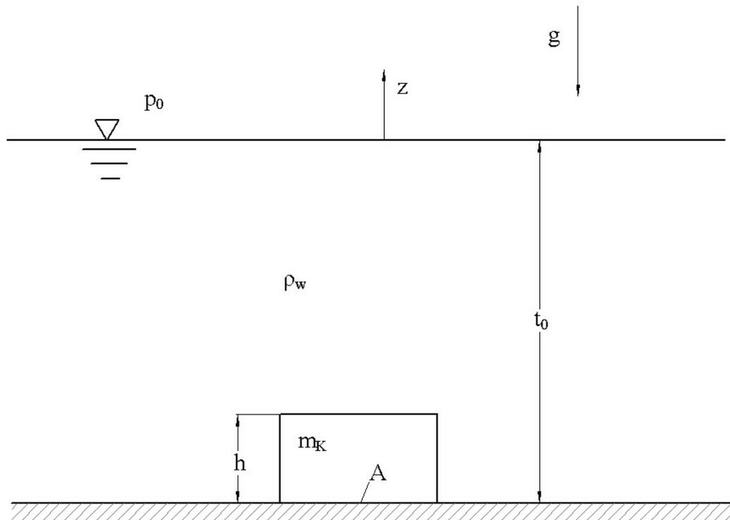
Gegeben:  $t_0 = 200 \text{ m}$   $m_K = 16\,000 \text{ kg}$
