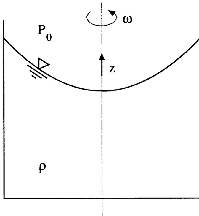
Eine zylindrische, mit der Winkelgeschwindigkeit  $\omega$  gleichförmig rotierende Trommel ist mit einer Flüssigkeit (Dichte  $\rho$ ) gefüllt.
