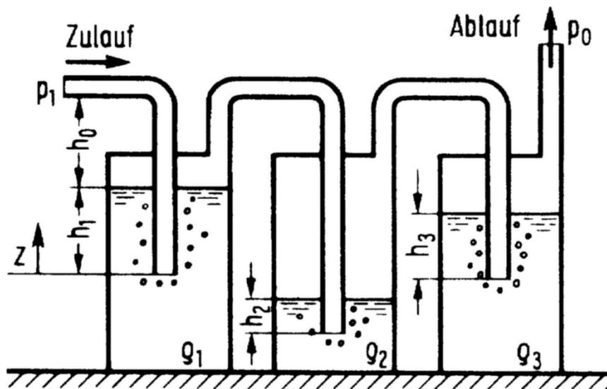
In der skizzierten Anordnung wird ein Gas dadurch gereinigt, dass man es langsam durch drei verschiedenen Flüssigkeiten strömen lässt.
