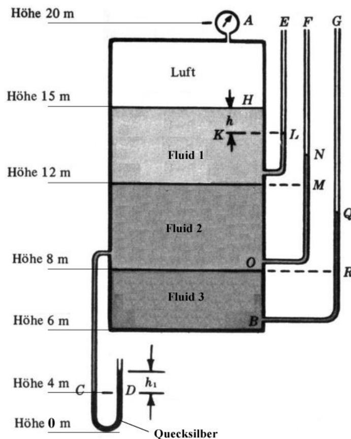
**Gegeben:**  $\rho_1 = 700 \text{ kg/m}^3$        $\rho_2 = 1000 \text{ kg/m}^3$        $\rho_3 = 1600 \text{ kg/m}^3$
