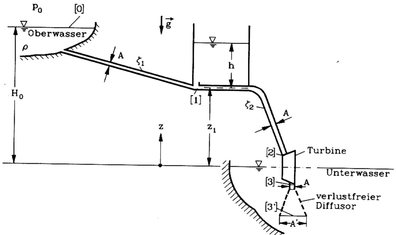
Verluste entstehen in der Rohrleitung zwischen dem See und dem Hilfsbehälter [1] (mit  $\lambda = 0,03$  und Länge  $L_{0-1}$ ) und am Auslauf aus dem Hilfsbehälter ( $\zeta_1 = 0,3$ ) sowie in der Rohrleitung zwischen [1] und Turbineneintritt [2] ( $L_{1-2}$ ) als auch im Krümmer und Turbineneintritt (zusammen  $\zeta_2 = 0,4$ ).
