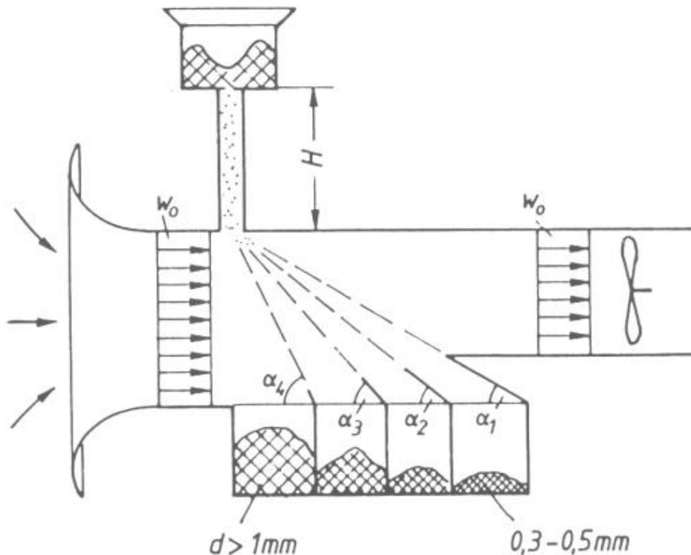
Die Körner haben etwa kugelige Gestalt, so dass zur Abschätzung Kugelwiderstandsbeiwerte benutzt werden können (abschätzen mithilfe des Diagramms aus der Vorlesung). Die Körner treten dabei mit ihrer stationären Sinkgeschwindigkeit  $w_\infty$  in den Luftstrahl ein. Die Dichte der Luft beträgt  $\rho_{\text{Luft}} = 1,25 \text{ kg/m}^3$ , die kinematische Viskosität  $\nu = 14,6 \cdot 10^{-6} \text{ m}^2/\text{s}$ .
