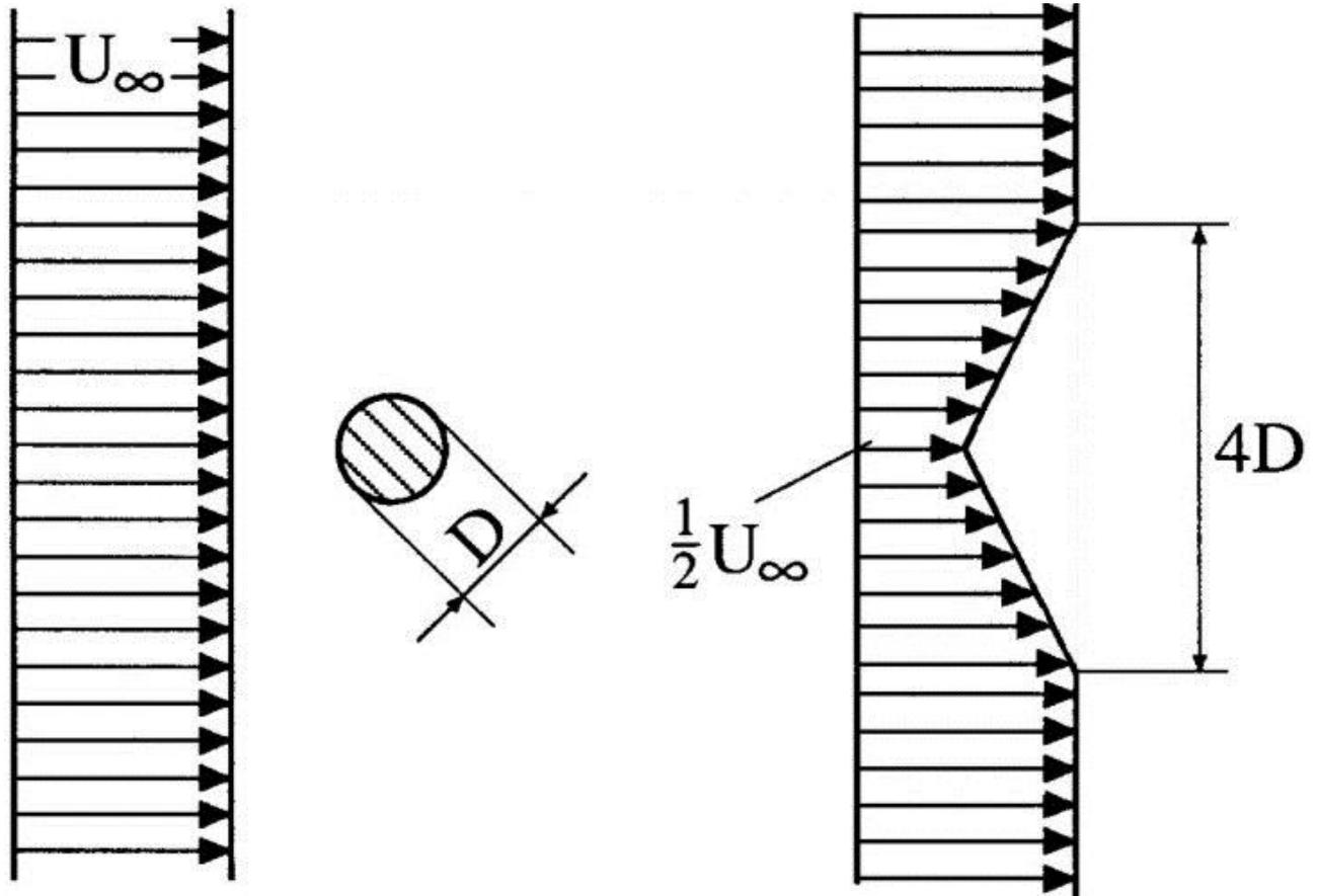
Zur experimentellen Bestimmung des Widerstandes eines Kreiszylinders mit dem Durchmesser  $D$  und der Breite  $b$  wird im Nachlauf sehr weit hinter dem Zylinder, wo der Druck bereits ausgeglichen ist, eine Geschwindigkeit gemessen, die entsprechend der Skizze einen linearen Verlauf zeigt.
