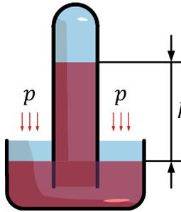
Das nebenstehende Flüssigkeitsbarometer ist eins vom Typ Quecksilberthermometer. Das erste hat **Evangelista Torricelli** im Jahre 1643 erfunden. Das obere Ende ist dicht verschlossen und in der Horizontallage nicht mit Luft oder einem anderen Gas gefüllt. In der abgebildeten Lage sinkt die Flüssigkeit durch ihr Eigengewicht in den Vorratsbehälter. Damit dieser Effekt überhaupt auftritt, verwendet man normalerweise Quecksilber für
