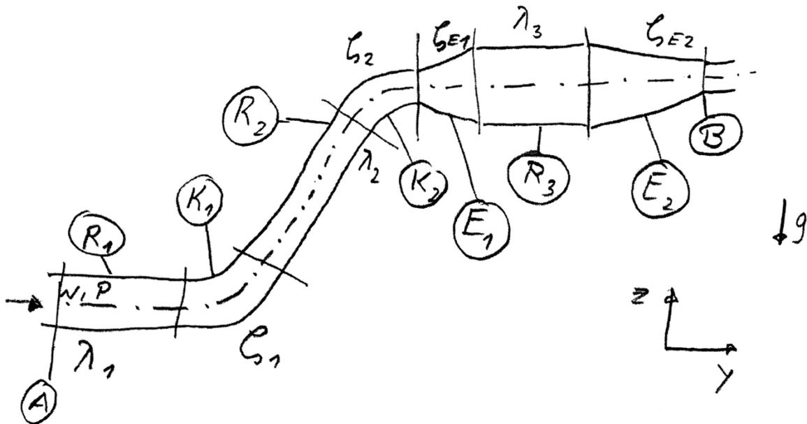
Wir sehen hier ein Rohrleitungssystem ohne Energiezu- oder -abfuhr, dafür aber mit Höhenunterschied und insbesondere mit geraden Rohrabschnitten, Rohrbögen, Erweiterungen und Verengungen. Das sind auch gleich die Elemente, die wir rechnerisch als Verursacher des Druckverlustes behandeln.
