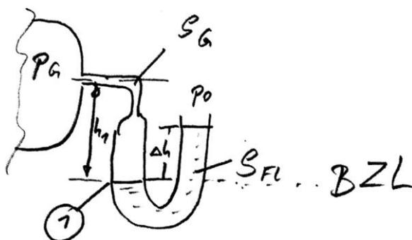
Die nebenstehende Skizze zeigt einen teilweise dargestellten Druckbehälter mit dem Fluid mit der Dichte  $\rho_G$ , an dem ein U-Rohr-Manometer (rechts) angeschlossen ist. Auf den linken Schenkel wirkt der Druck des Behälters  $p_G$ , und die Fluidsäule des im Druckbehälter befindlichen Fluids, auf den rechten Schenkel der Referenzdruck  $p_0$ . Die Flüssigkeit habe die Dichte  $\rho_{FL}$ .
