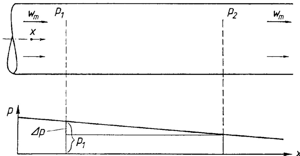
Der untere Bildteil zeigt den Verlauf des Drucks über der Länge in  $x$ -Richtung. Durch die Reibung, die in der Strömung entsteht (siehe Kapitel 6) entsteht ein Druckabfall. Das heißt, dass Druckenergie „verloren geht“. Durch die Reibung wird irreversibel Wärme produziert. Die Energie, die vorher – hier an der Stelle (1) – noch vorhanden war, fehlt als Druckenergie, besteht jetzt jedoch als Wärmeenergie fort. Dies äußert sich durch einen Temperaturanstieg in einer reibungsbehafteten Strömung.
