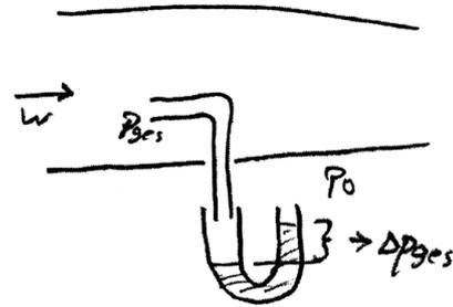
Der Gesamtdruck, der durch das Pitot-Rohr detektiert wird, ist höher als der statische Druck in der Strömung. Die Manometeranzeige im Tafelbild illustriert diesen Umstand.
