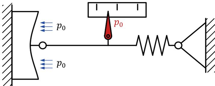
Man kann Barometer auch auf mechanische Art aufbauen, indem eine Federkraft den Druckkräften entgegenwirkt. In der nebenstehenden Abbildung sehen Sie ein Barometer mit einer Membrandose. Das Prinzip ist in den
