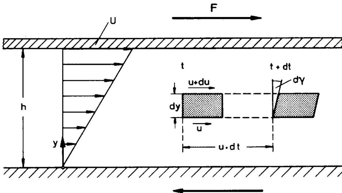
Die Abbildung hier oben deutet an, was wirklich geschieht. Das Bild zeigt als festgehaltenen Moment, wie eine Platte (oben) mit der Geschwindigkeit  $u$  von links nach rechts bewegt wird. Die untere Fläche steht fest. Dabei stellt sich das dargestellte Bild der Geschwindigkeiten der Fluidteilchen dar. Dabei geben die Pfeillängen die Geschwindigkeit dar.
