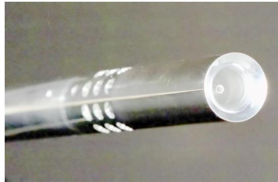
In den obenstehenden beiden Abbildungen sehen Sie praktisch ausgeführte ummantelte Pitot-Rohre.
