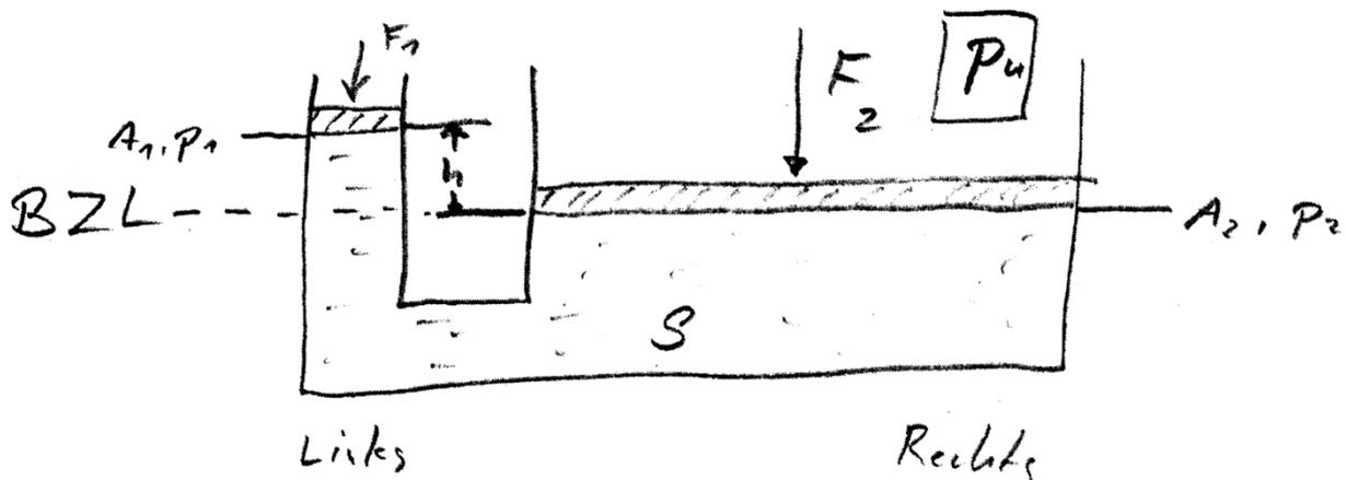
Auf den Flüssigkeitsspiegeln liegen Kolben mit den Flächen  $A_1$  und  $A_2$  auf, deren Masse hier vernachlässigt werden soll. Auf die Kolben wirken noch die Kräfte  $F_1$  und  $F_2$  und der Umgebungsdruck  $p_u$ . Nicht wundern bitte! Der **Umgebungsdruck** heißt hier  $p_u$ . Manchmal wird auch  $p_\infty$  verwendet.
